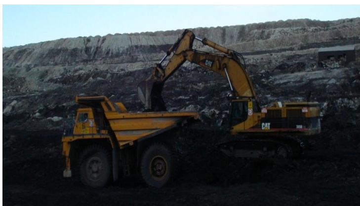
Slika 4: Rad hidrauličnog bagera kašikara CAT 385B na površinskom kopu
