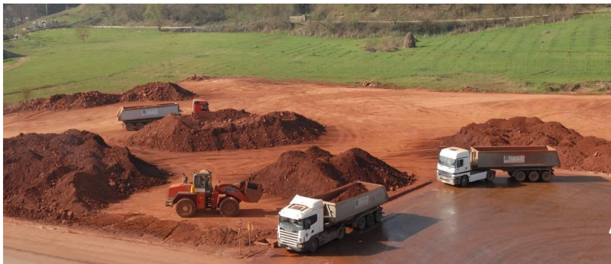
Slika br. 3. Utovar i homogenizacija rude
