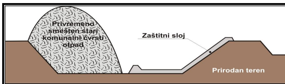
Slika 2 – Šematski prikaz jednog od načina sanacije u okviru stare komunalne deponije (M. Rakijaš,)
