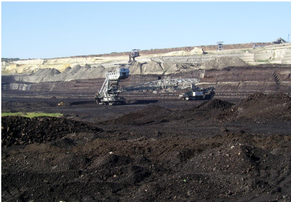
Slika br.6 Rotorni bager SRs1300x26/5+VR(G-VIII) na otkopavanju uglja
